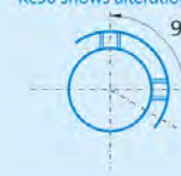
变更止动螺丝角度用KC90表示
