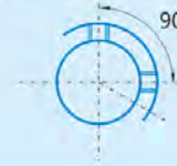
变更止动螺丝角度用KC90表示
