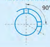
变更止动螺丝角度用KC90表示
