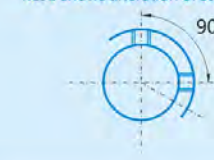
变更止动螺丝角度用KC90表示
