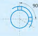
变更止动螺丝角度用KC90表示
