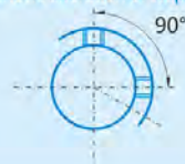
变更止动螺丝角度用KC90表示
