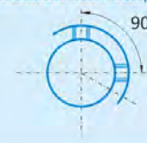
变更止动螺丝角度用KC90表示
