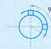
变更止动螺丝角度用KC90表示
