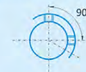
变更止动螺丝角度用KC90表示
